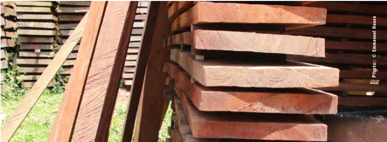
Photo 13 Séchoirs semi-naturels, permettant une légère amélioration de la qualité des bois non industriels avant leur utilisation en menuiserie et en charpenterie
