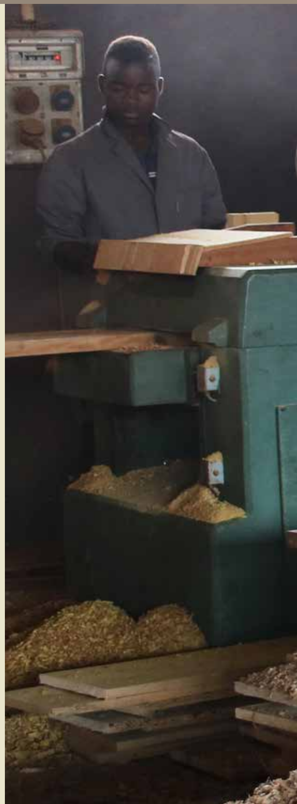
Photo 11 Un mauvais sciage et l'absence de séchage affectent souvent très négativement le rendement matière du secteur artisanal
